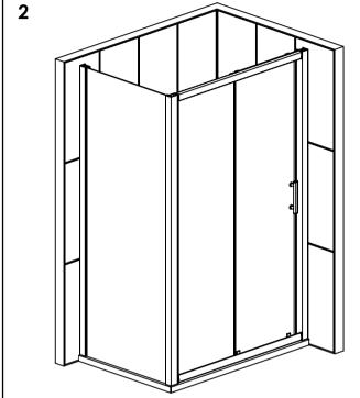
SLIDE THE SIDE PANEL INTO THE REAR WALL PROFILE, THEN SILDE THE CORNER POST ONTO THE ENCLOSURE / DOOR.
